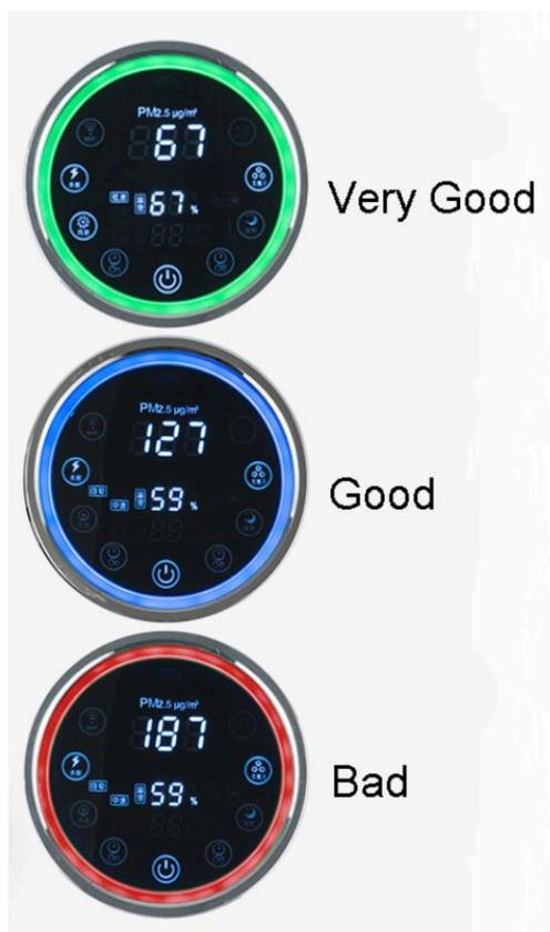
Varianti di colorazione della corona a led del display (per indicazione rapida della qualità dell'aria)
