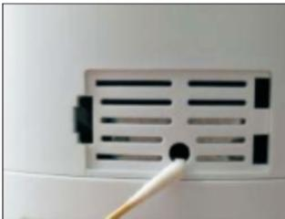
2) E' possibile pulire il sensore con un bastoncino in cotone (ruotarlo delicatamente)
